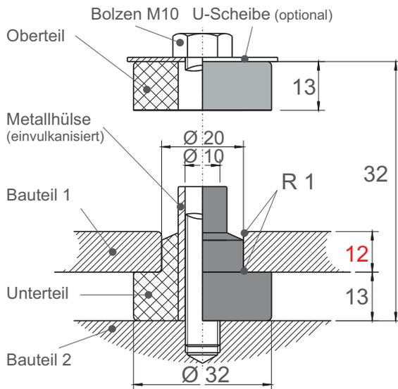
Die Angaben für Federeigenschaften und Eigenfrequenzverlauf gelten für eine Klemmhöhe von **12 mm** (Bauteil 1). Bei abweichender Höhe kontaktieren Sie uns bitte. Sie sind Anhaltswerte und können aufgrund der Fertigungstoleranz der Elastomere etwas abweichen.
