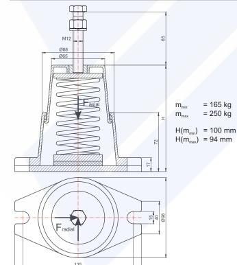
Die Angaben für Federeigenschaften und Eigenfrequenzverlauf sind Anhaltswerte und können aufgrund der Fertigungstoleranzen etwas abweichen.
